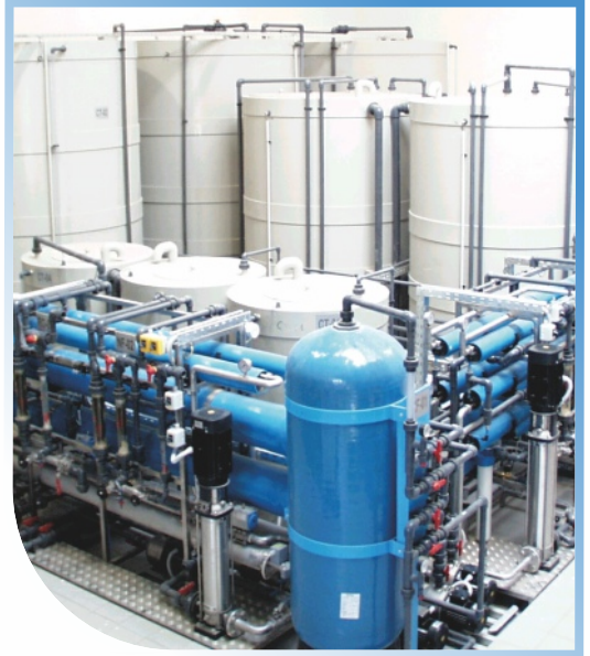
Oczyszczanie i zwracanie ścieków z produkcji części lotniczych w technologii ZLD. GE Aviation Hungary Ltd. / Węgry 100 m 3 /dzień
