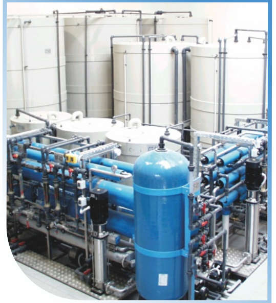
ZLD 기술로 항공기 부품 제조 시 발생하는 폐수를 정화 및 재활용합니다. GE Aviation Hungary Ltd. / 헝가리 100 m 3 /일
