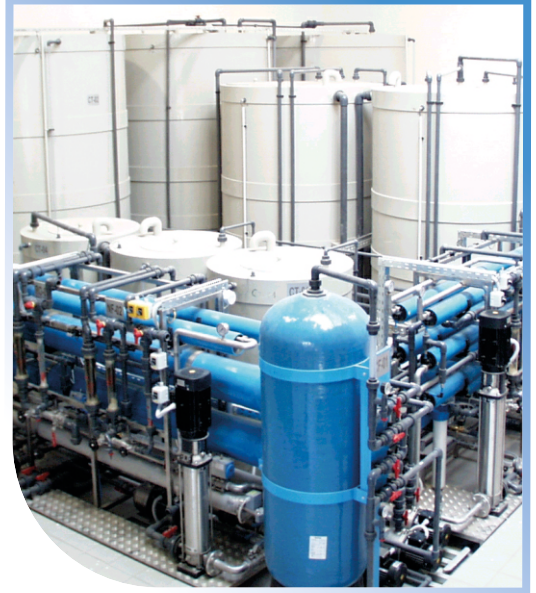
Repülőgép alkatrész gyártás során keletkező hulladékvíz tisztítása és visszaforgatása a technológiába. GE Aviation Hungary Kft. / Magyarország 100 m 3 /nap
